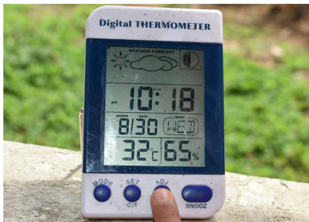
Nuevamente, presionar el tercer botón (ADJ MAX/MIN) del tablero del termohigrómetro
