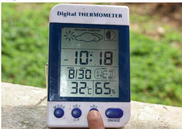
Presionar el tercer botón (ADJ MAX/MIN) del tablero del termohigrómetro
