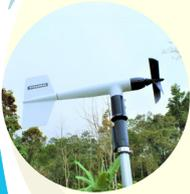
Mide la velocidad y la dirección del viento. La velocidad se mide en metros por segundo (m/s) y la dirección en grados ( $^{\circ}$ ).
