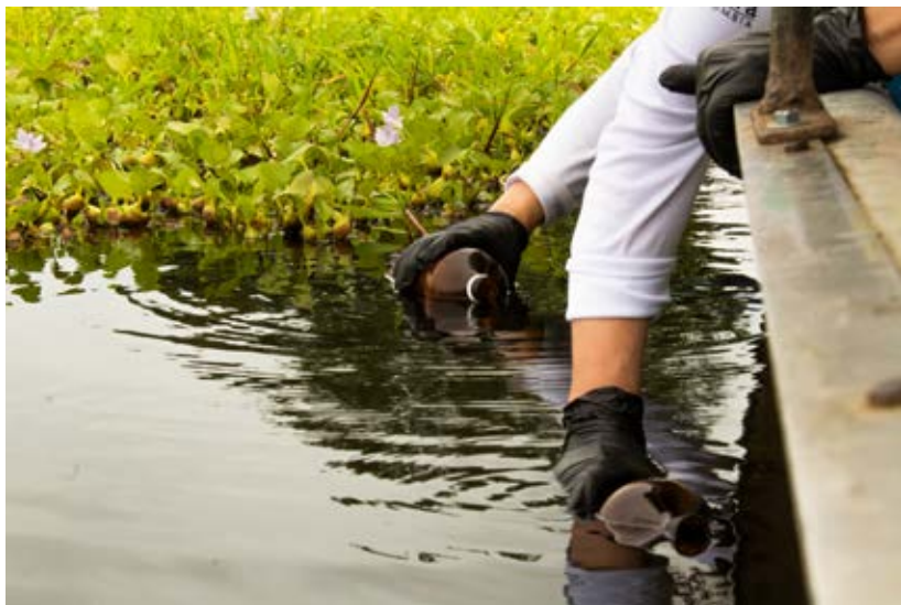
Toma muestras de agua para parámetros físico-químicos
