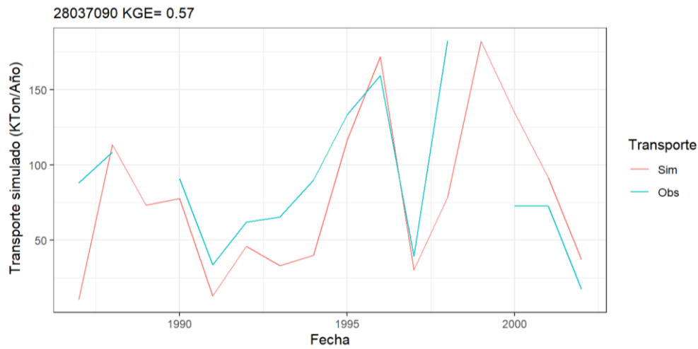
Figura 3-36. Transporte de sedimentos anual para la estación Puente Canoas
