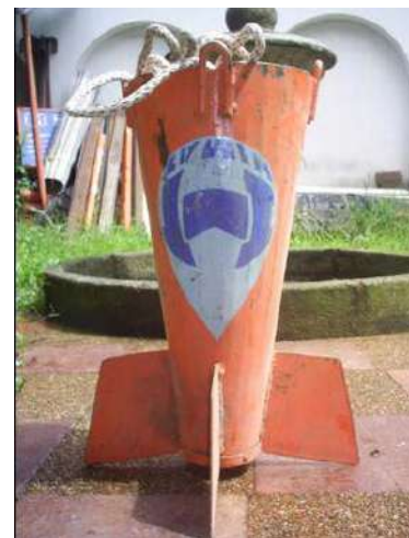
Figura 8-78. Muestreador de material de fondo usado en IDEAM. Fuente: (IDEAM, 2009).
