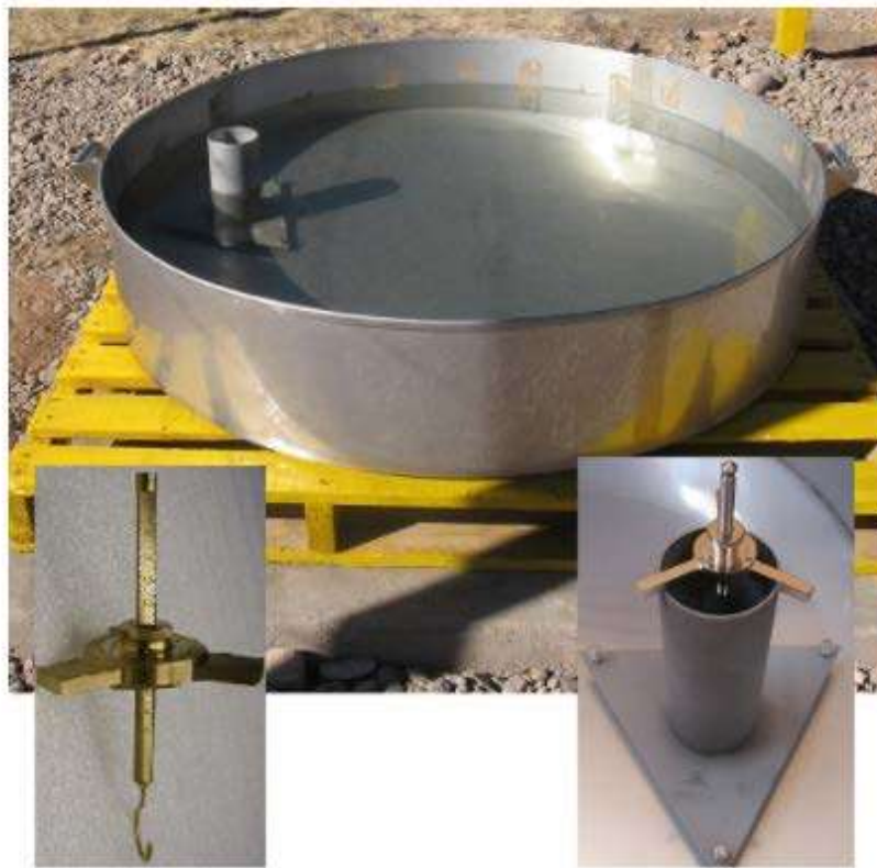
Figura 7-19. Tanque evaporímetro clase "A" con gancho graduado y tanque tranquilizador. Fuente: (Agromatic S.A., 2019).
