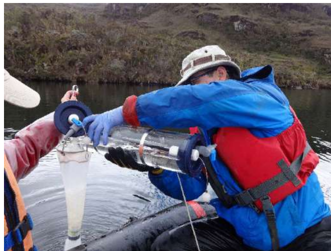
Figura 8-139. Concentración de muestra con botella Van Dorn y red de plancton.
