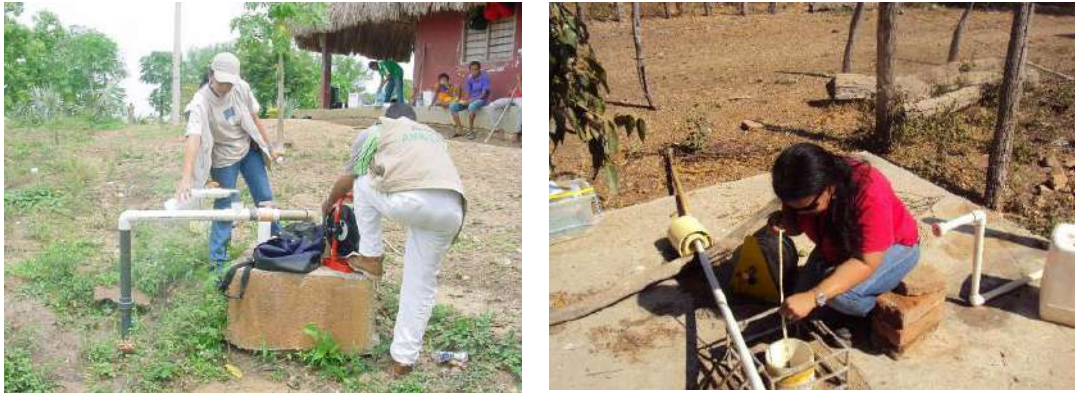
Figura 9-22. Medición de nivel piezométrico. Izquierda: CARSUCRE. Derecha: CORPOGUAJIRA.
