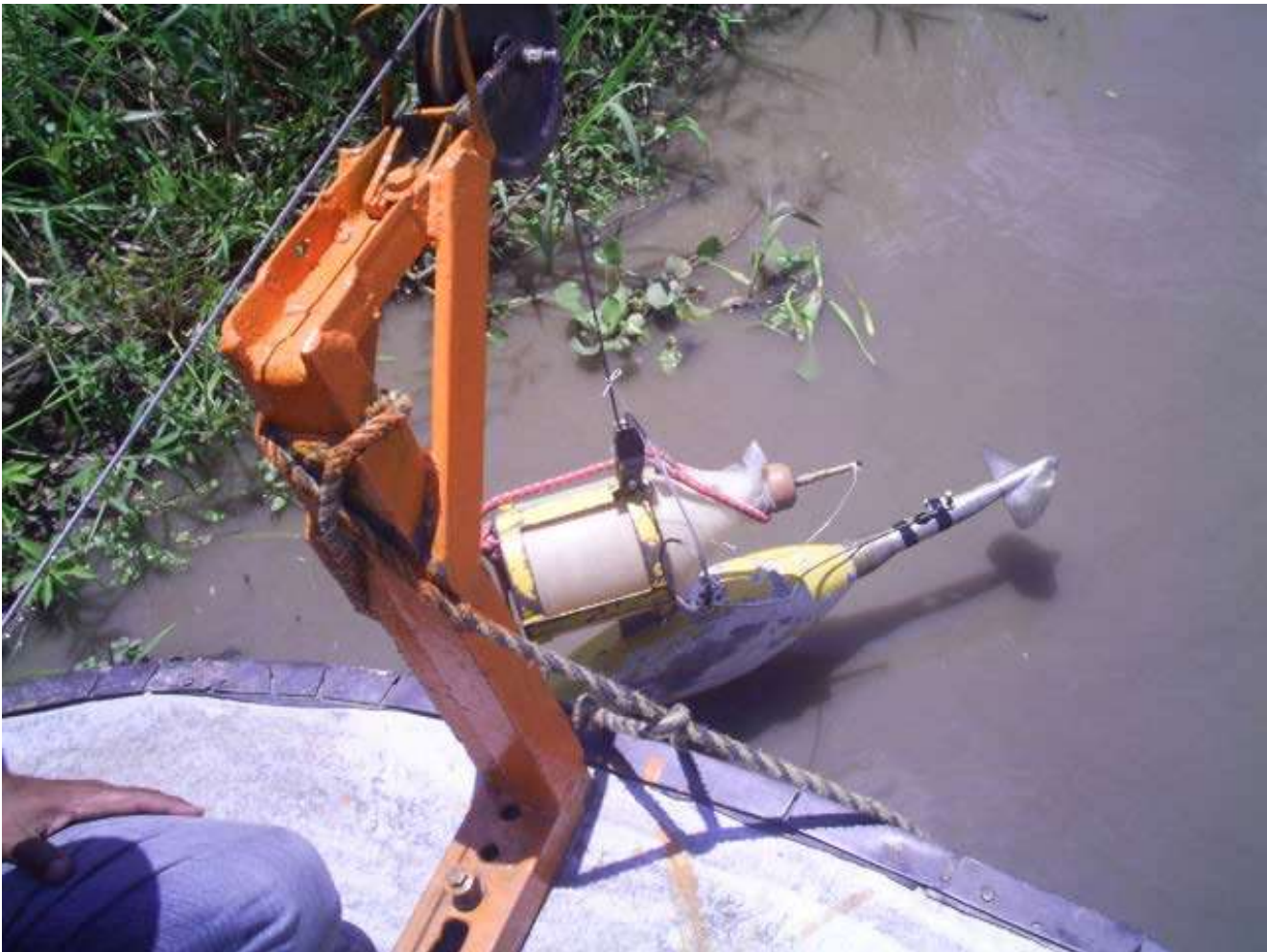
Figura 8-74. Uso del muestreador en aforo de bolsa plegable. Fuente: (IDEAM, 2009).
