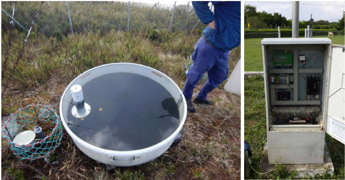
Figura 7-21. Izquierda: Tanque de evaporación automático. Derecha: Gabinete donde se ubica el Datalogger utilizado por el IDEAM en sus estaciones meteorológicas.
