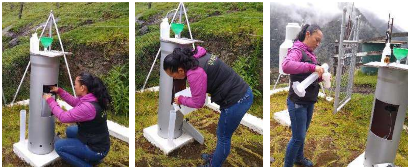
Figura 10-21. Muestreo de un totalizador Palmex, referencia Rain Sampler, ubicado en la Estación La Montaña-CRQ.
