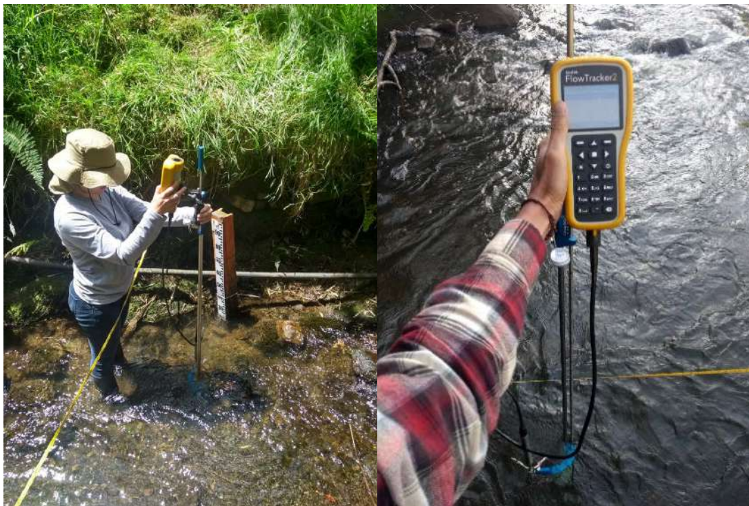
Figura 8-33. Medición en campo con equipo caudalímetro FlowTracker2.
