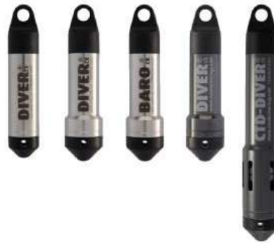
Figura 9-12. Registradores compactos tipo Divers, para la medición y el registro automático del nivel del agua subterránea, conductividad y temperatura. Fuente: (Schlumberger Water Services, 2014)
