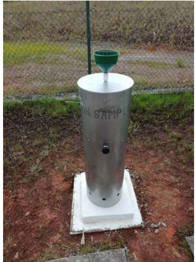
Figura 10-9. Izquierda. Totalizador Rain Sampler RS1. ubicado en las instalaciones del Área Operativa 07- Pasto- IDEAM. Derecha: Totalizador Rain Sampler RS2, instalado en la estación climatológica del IDEAM, del Aeropuerto El Caraño, en Quibdó. Red Nacional de Isotopía-IDEAM.
