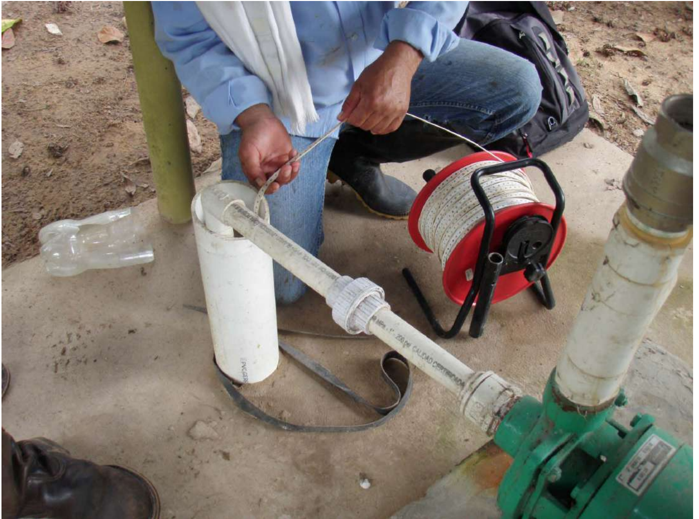
Medición de niveles piezométricos. ■ Ana María Vesga
