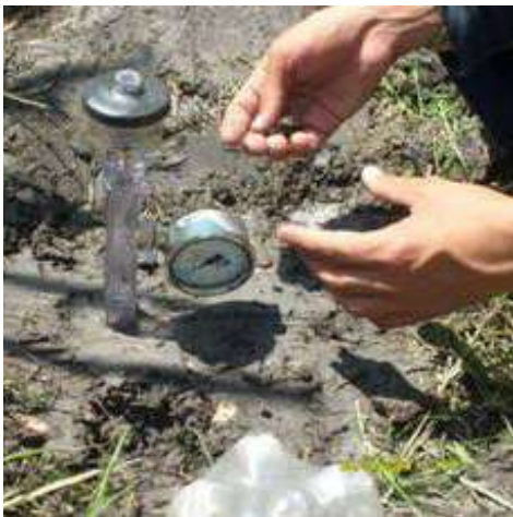
Figura 9-4. Muestreo en la zona no saturada, con el uso de tensiómetros y de lisímetros-CVC.
