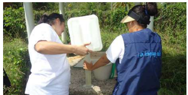
Figura 10-20. Medición con probeta de la lluvia acumulada en un totalizador enterrado que hace parte de la estación isotópica de la Red Nacional de Isotopía del IDEAM ubicada en San Andrés Islas.
