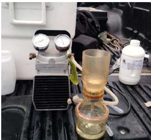
Equipo de filtrado compuesto de bomba de vacío y recipiente de filtrado. ■ Juliana Ossa- Ana María Vesga
