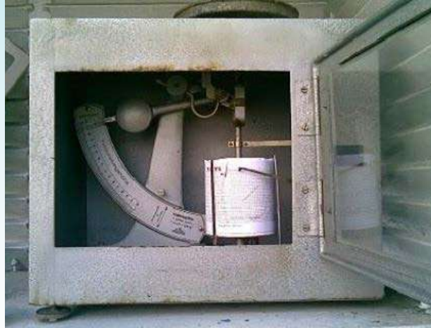
Figura 7-24. Izquierda: esquema de evaporímetro tipo Wild. Derecha: Evaporímetro tipo Wild. Fuente: (Ruiz & Martínez, 2015), (Martínez, 2012).
