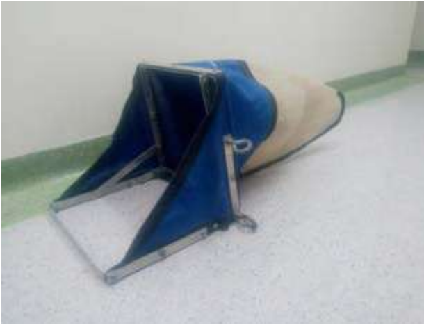
Figura 8-161. Red tipo Surber. Fuente: (Laboratorio de Calidad Ambiental IDEAM, 2017).
