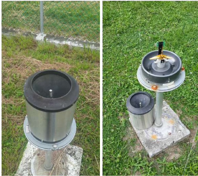
Figura 7-8. Pluviómetro de balancín utilizado en algunas estaciones del IDEAM.
