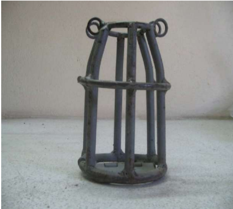
Figura 8-75. Canastilla de hierro soldado para botellas ½ l. Fuente: (IDEAM, 2009).
