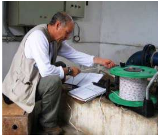
Figura 9-16. Uso de sonda eléctrica para medición de niveles de agua en el pozo de bombeo. Fuente: (Valencia, s.f.).
