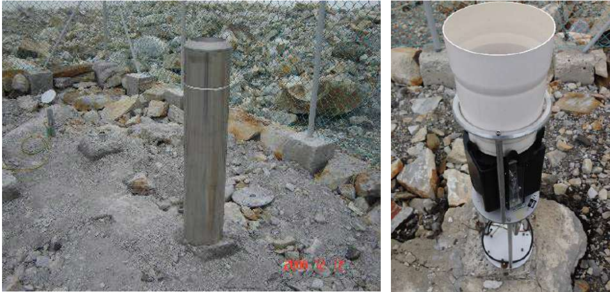
Figura 7-10. Pluviómetro de peso ubicado en la Sierra Nevada El Cocuy.
