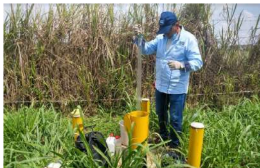
Figura 10-29. Toma de muestras de agua subterránea de un piezómetro a través de un bailer. Fuente: CVC.
