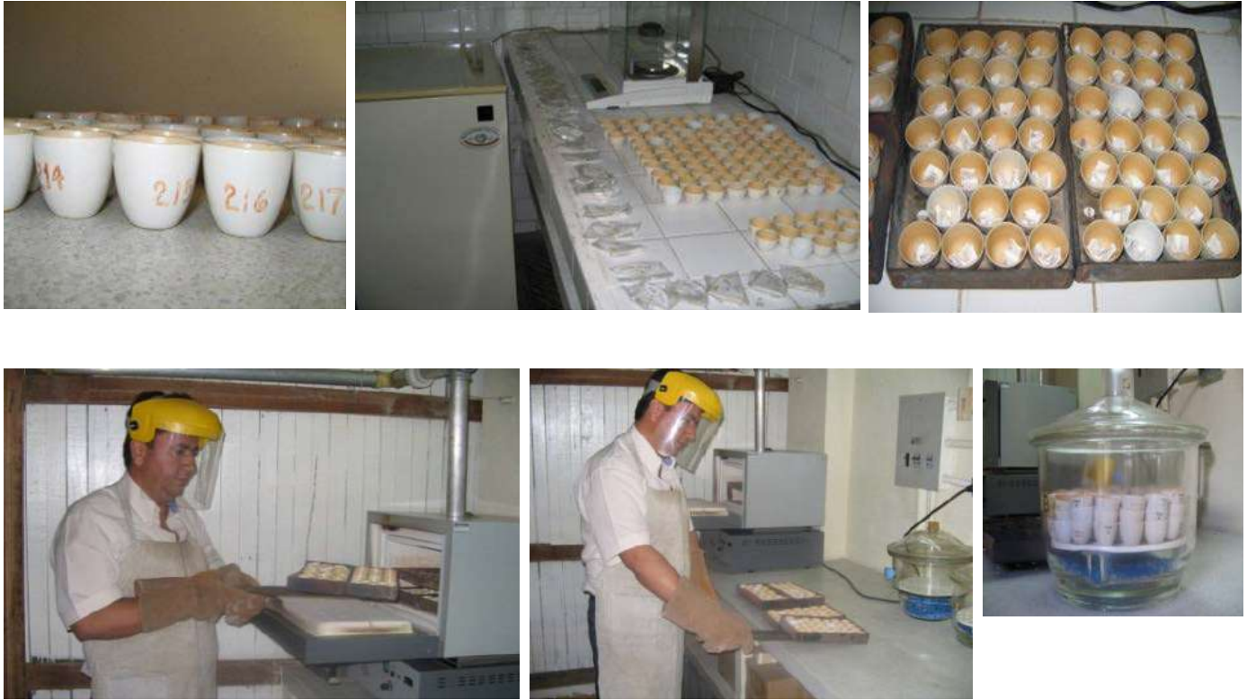
Figura 8-110. Aspectos del procedimiento de calcinación. A: Numeración de los crisoles en base y al lado con cloruro férrico. B: Orden de filtros y crisoles C: Cargue de filtros en crisoles y bandejas. D: Cargue de crisoles en mufla por 30 min. E: Enfriamiento a 200 °C y retiro de crisoles. F: Enfriamiento a temperatura ambiente en desecador, antes del pesaje. Fuente: (IDEAM, 2009).
