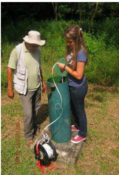
Medición de niveles piezométricos con sonda de señal acústica. ■ CARSUCRE
