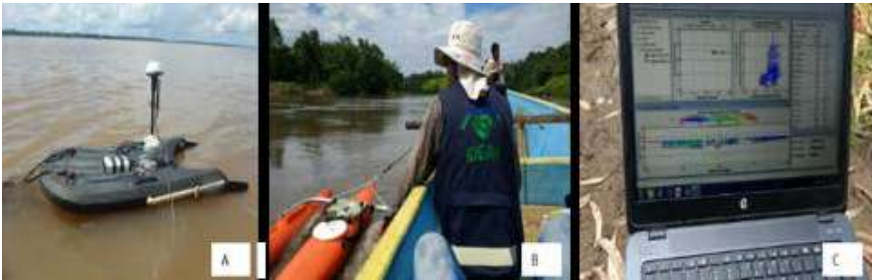
Figura 8-29. Medición de caudal con ADCP. A: Río Amazonas. B: Río San Juan. C: Transmisión del ADCP al computador. Estación Rumichaca, río Guaitara.
