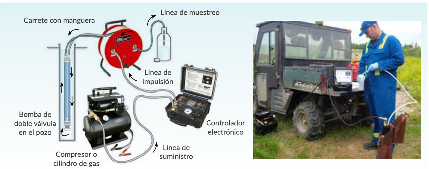
Figura 9-37. Funcionamiento de la bomba vejiga. Fuente: (Solinst, 2021).
