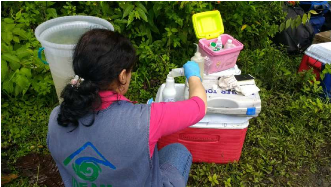
Figura 8-126. Preservación de muestras con ácido en Estación Pipiguay.
