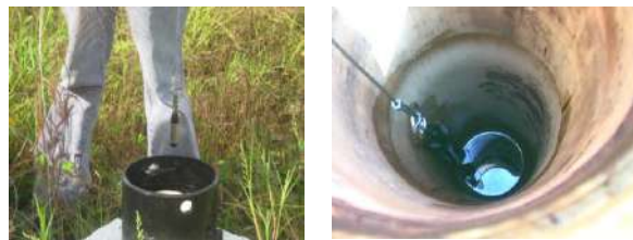
Figura 9-24. Instalación de un Diver en un pozo de monitoreo-CORPOURABÁ.
