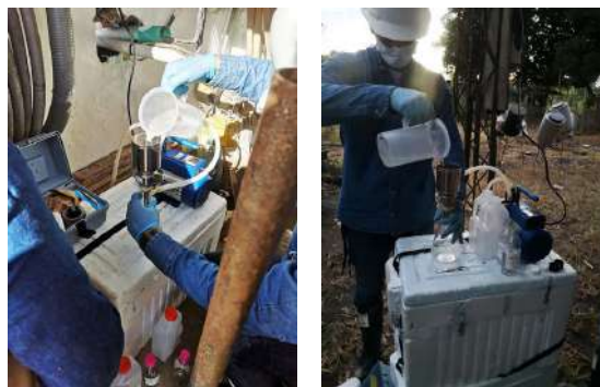
Figura 10-34. Proceso de filtrado de muestra de agua subterránea utilizando equipo que incluye embudo de filtración, frasco de vacío y una bomba de vacío. Fuente: Ana María Vesga
