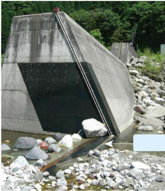
Figura 8-83. Geófono de tubería ubicado en una superficie estable del lecho de una presa en el río Joganzi, Japón. El flujo es de derecha a izquierda. Fuente: (Gray J. et al., 2010).
