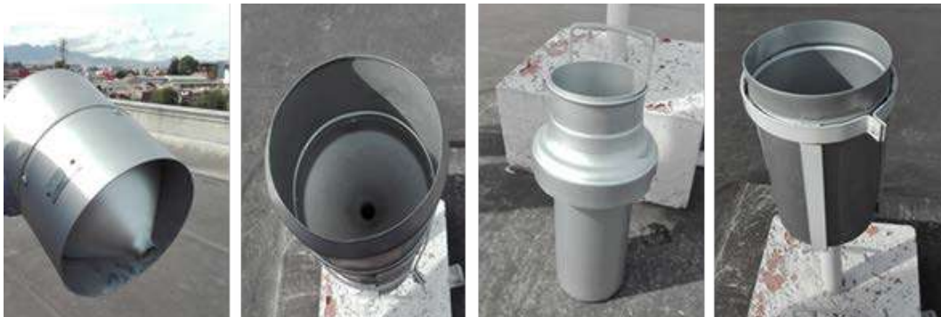
Figura 7-3. Elementos de un pluviómetro: A, B: Embudo colector. C: Cilindro interior o depósito. D: Cilindro exterior.
