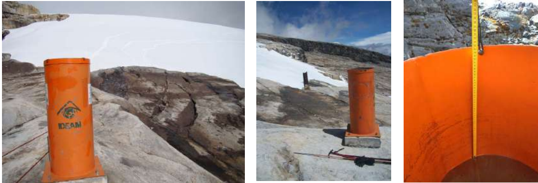
Figura 7-5. Pluviómetro totalizador de nieve del IDEAM ubicado en el Nevado del Cocuy-Ritacuba Blanco.
