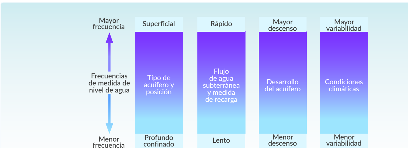
Figura 9-5. Factores para determinar la frecuencia de monitoreo de niveles de agua subterránea. Fuente: (Taylor & Alley, 2001. Tomado y modificado de ACWI, 2009).
