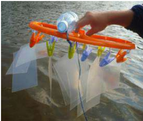
Figura 8-151. Proceso de instalación y recolección de sustratos artificiales para la obtención de las muestras de la comunidad perifítica. Fuente: (Andramunio, 2013).
