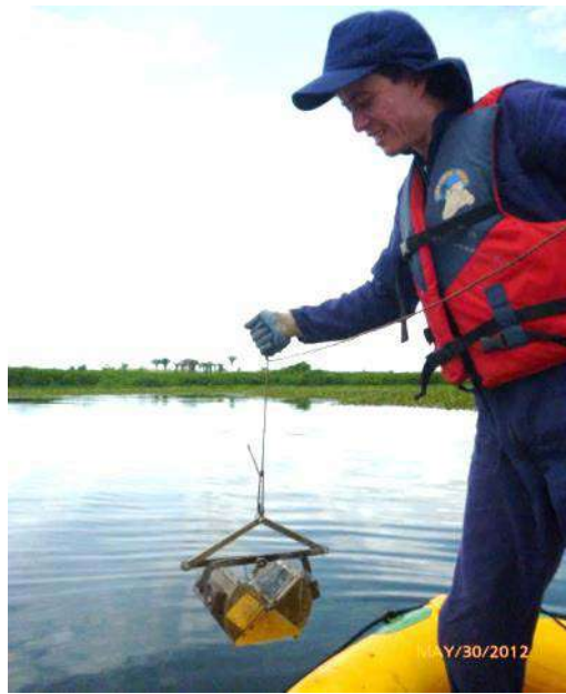
Figura 8-168. Draga tipo Petersen utilizada para la toma de muestras de bentos. Fuente: (UJTL, 2018).
