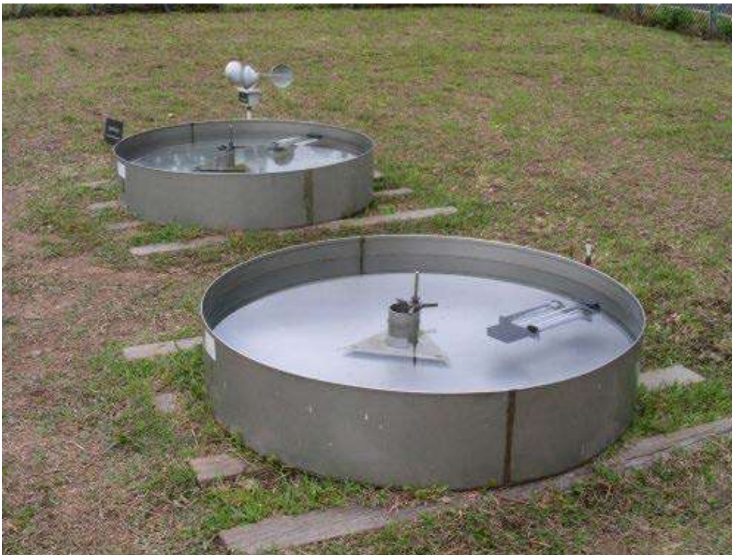
Figura 7-20. Detalle de un tanque de evaporación. Fuente: (Hong Kong Observatory, 2019).
