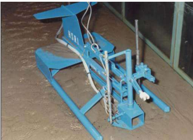
Figura 8-77. Muestreador del Delta del Nilo para material de fondo. Fuente: (Van Rijn, 2006).
