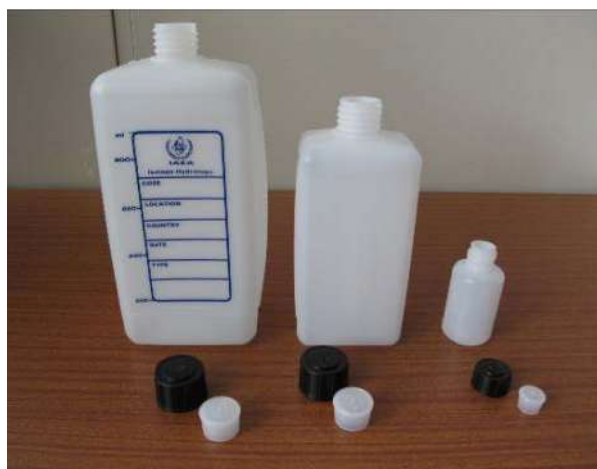
Figura 10-17. Frascos de muestreo isotópico de ^2\text{H} , ^{18}\text{O} y ^3\text{H} 50 y 500 ml de PEAD. Fuente: (OIEA/GNIP, 2014).
