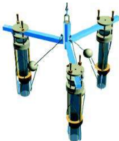
Figura 11-10. Multimuestreador de gravedad (Multicore). Fuente: (UWITEC, 2019).
