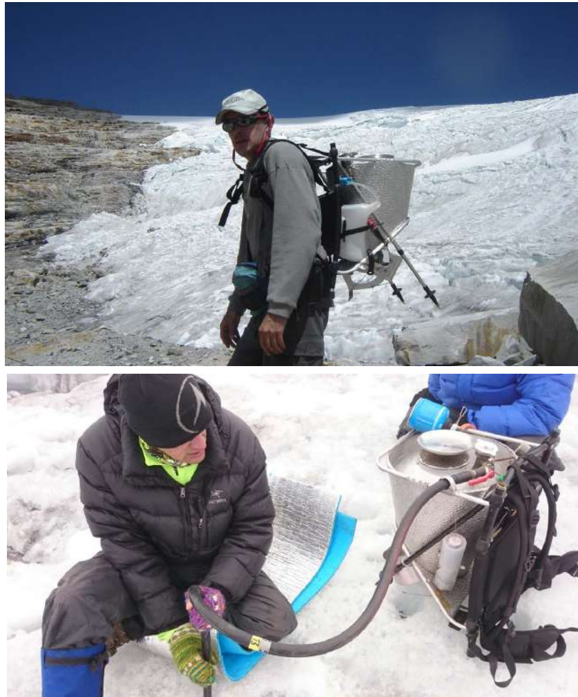
Figura 8-58. Izquierda: Detalle de perforadora Heucke. Derecha: Perforación de hielo empleando la perforadora Heucke.
