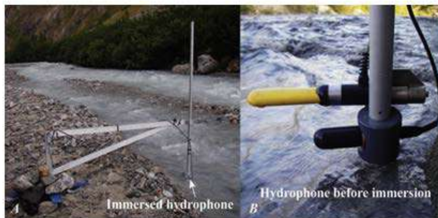
Figura 8-88. Un hidrófono (A) en poder de un marco fijo en el Torrent de Saint-Pierre, Francia, y (B) en el marco antes de la inmersión. Fuente: (Gray J. et al., 2010).
