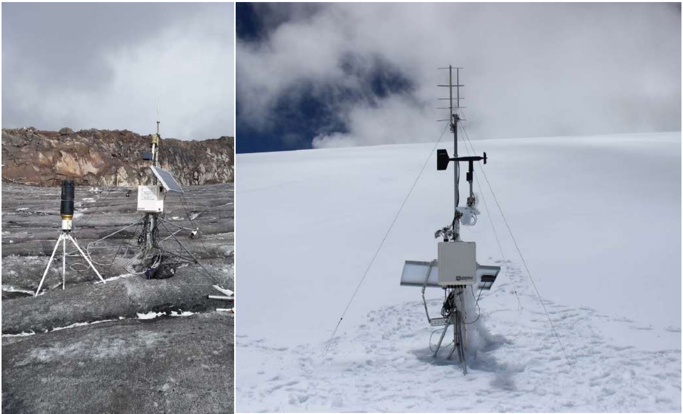
Figura 7-12. Pluviómetro EMMA (Estación Meteorológica Móvil de Altitud). Izquierda: Parque Nacional Natural Los Nevados, Derecha: Sierra Nevada El Cocuy-Ritacuba Blanco.
