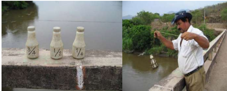
Figura 8-92. Botellas plásticas de 500 cm 3 y proceso de toma de muestras. Fuente: (IDEAM, 2009).
