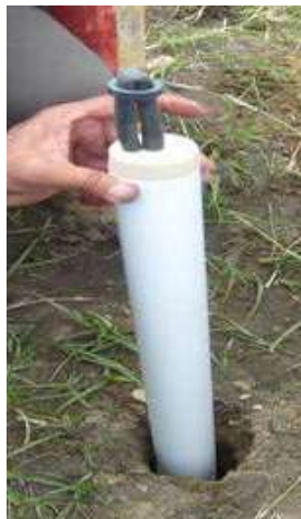
Figura 9-4. Muestreo en la zona no saturada, con el uso de tensiómetros y de lisímetros-CVC.
