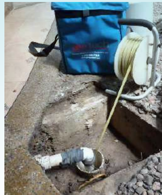
Figura 9-18. Izquierda: Monitoreo de niveles realizado en el municipio de Puerto Gaitán. Derecha: Esquema que ilustra la medición de niveles con el uso de una sonda manual. Fuente: (CORMACARENA & SIAM S. A., 2016), (HYDROTECHNIK, s.f.).
