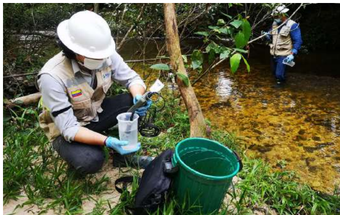
Medición in situ de parámetros físicoquímicos utilizando una sonda multiparamétrica. Quebrada La Gómez-Sabana de Torres- Santander Ana María Vesga
