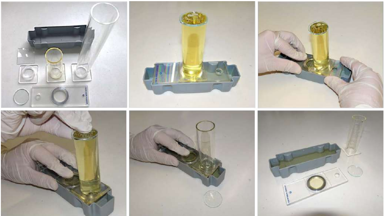
Figura 8-136. Proceso de sedimentación de una muestra de fitoplancton. Fuente: (Villafañe & Reid, 1995).
