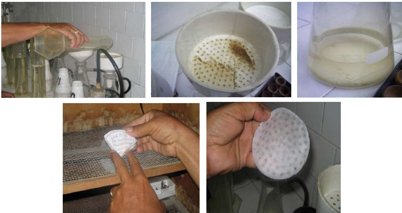
Figura 8-109. Aspectos del procedimiento de filtración. A: Vertido del contenido de las probetas en los embudos con bomba de vacío prendida. B, C: Revisión de que no haya quedado sedimento en embudo, botella y probeta. D, E: Retiro, doblado y almacenamiento de filtros en horno de madera. Fuente: Laboratorio de Calidad Ambiental del IDEAM.
