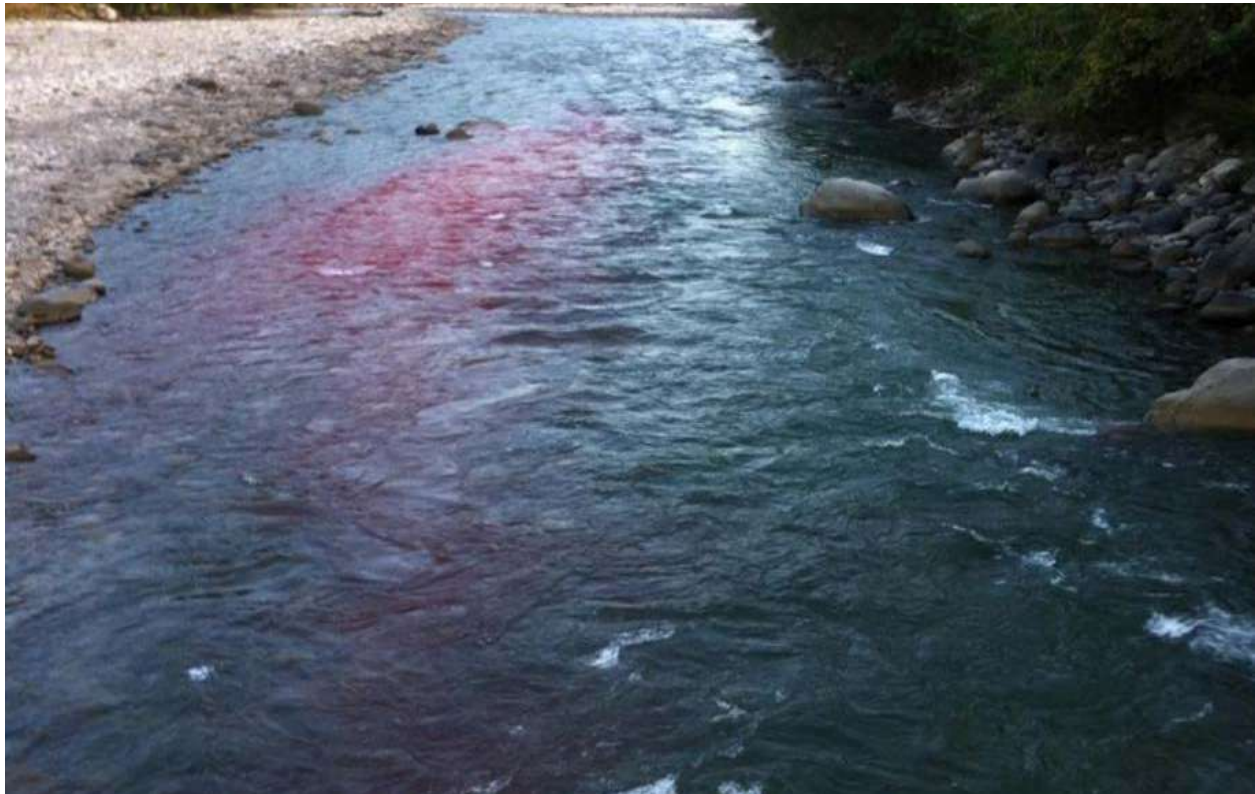
Figura 8-37. Ensayo con trazadores en el río Cravo Sur en el sector de La Cabaña, Yopal, Casanare. Fuente: (Archivo Empresa Fluvia, 2014).
