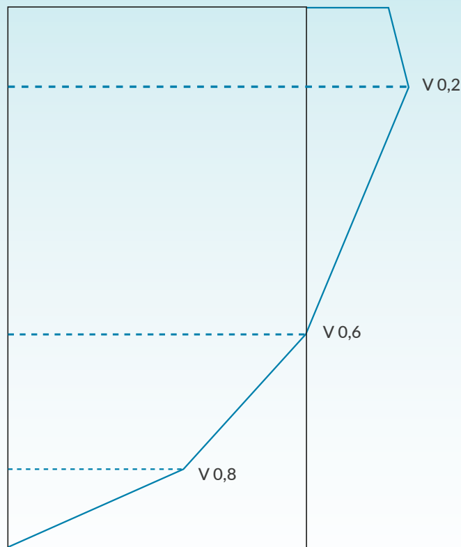
Figura 8-20. Método de tres puntos (20%-60%-80 %) para la medición de la velocidad del flujo en la vertical. Fuente: (IDEAM, 2006).
