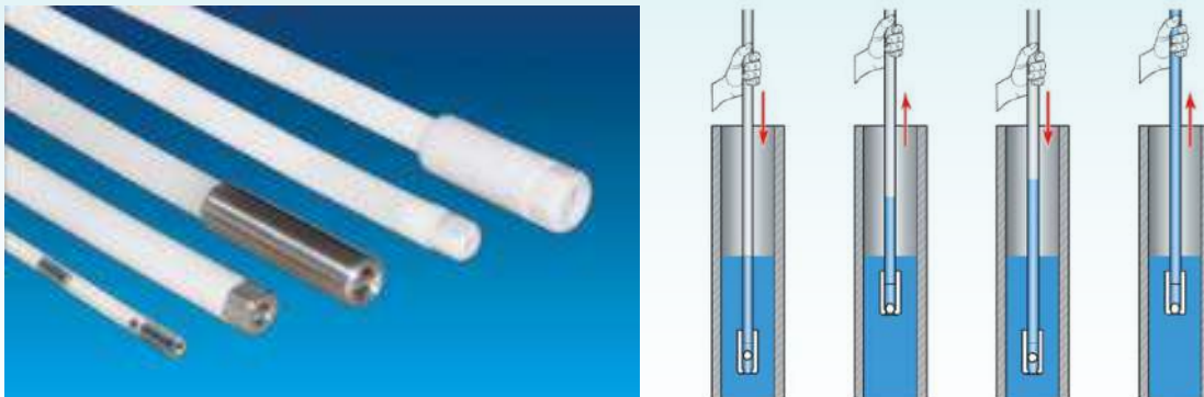
Figura 9-38. Izquierda: Bomba inercial. Derecha: Mecanismo de operación de la bomba inercial. Fuente: (Solinst, 2021)
