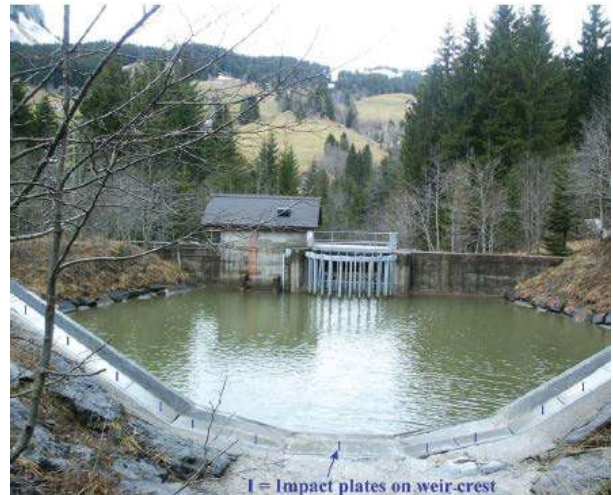
Figura 8-84. Placa de Impacto para medir el transporte de carga sólida en la corriente Erlenbach, Suiza (vista aguas abajo, con placas visibles en primer plano). Fuente: (Gray J. et al., 2010).
