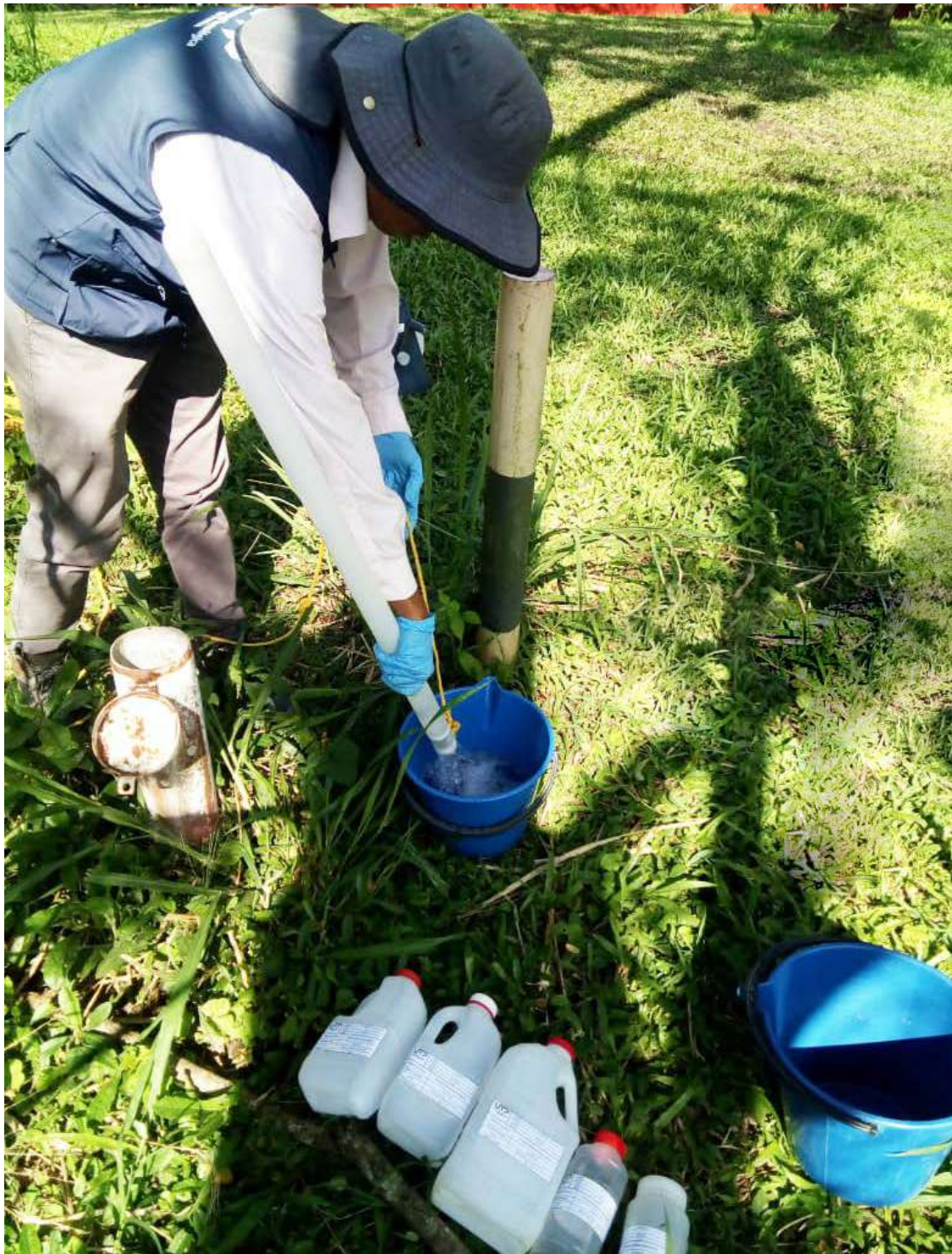
Mediciones de calidad de un piezómetro, utilizando un muestreador bailer. CORPOCALDAS
