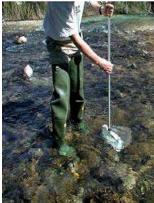
Figura 8-167. Toma de muestra de macroinvertebrados acuáticos con red rectangular. Fuente: (Alba-Tercedor et al., 2005).
