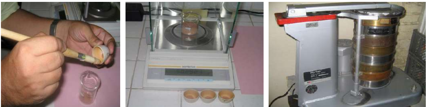
Figura 8-111. Aspectos del procedimiento para la granulometría del material de fondo. A: Pesaje de las muestras del aforo. B: Si el pesaje es >0.5 g se pasan al análisis granulométrico. C: Colocación de la muestra en el primer tamiz y agitación de 15 min. Fuente: (IDEAM, 2009).
