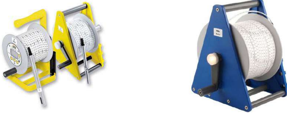
Figura 9-8. Sonda de nivel de agua con señal acústica y luminosa, con marco y carrete. Fuente: (OTT, 2019) (Maser, 2021)
