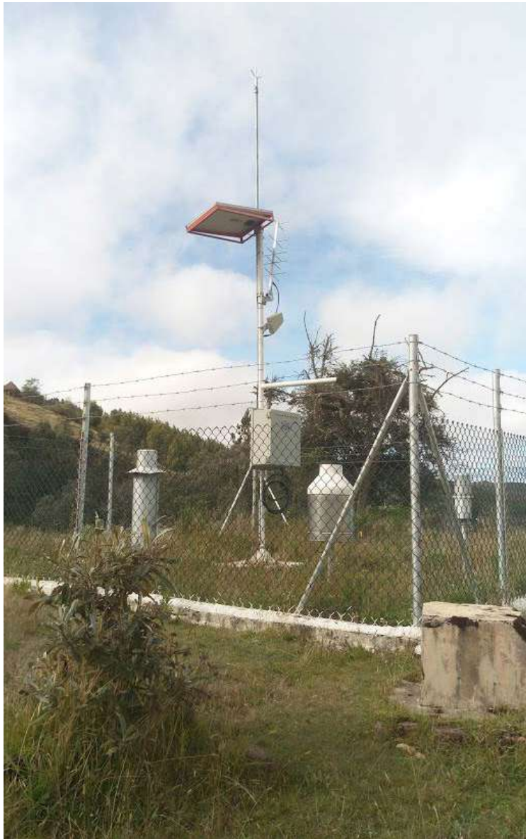
Figura 7-13. Pluviómetro convencional y pluviómetro automático ubicados en la estación meteorológica Las Cintas.
