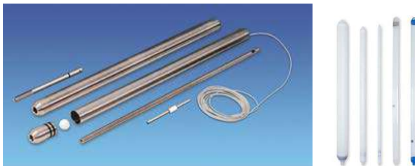
Figura 9-39. Tipos de bailers para muestreo de agua subterránea. Izquierda: Bailers en acero inoxidable. Derecha: Bailers en plástico. Fuente: (Envirotechnics, 2021)
