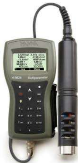
Figura 10-26. Medidor multiparámetro portátil de temperatura y pH / EC / TDS. Fuente: (Hanna Instruments, 2020).
