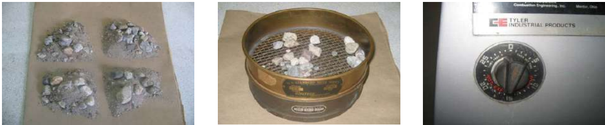
Figura 8-112. Aspectos del procedimiento para la granulometría del material en suspensión. A: Cuarteo de la muestra seca y toma de dos diagonales para la determinación. B: Paso de la muestra por los tamices 6.350 y 4.760 micras. C: Paso a microtamices y a la tamizadora por 15 min. Fuente: (IDEAM, 2009).
