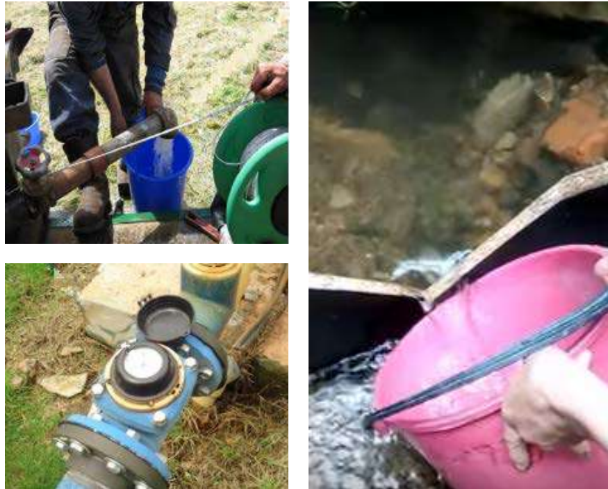
Figura 9-17. Izquierda: medición de caudales por métodos volumétricos de aforo y medidor de corriente. Derecha: aforo de caudales pequeños. Fuente: (Valencia, s.f.).
