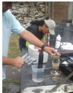
Figura 10-30. Medición in situ de parámetros fisicoquímicos utilizando una sonda multiparamétrica. Fuente: CRQ
