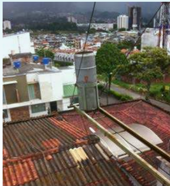
Figura 10-2. Pluviómetro convencional utilizado para muestreo con base de eventos o con transferencia diaria. Izquierda: Esquema del pluviómetro. Derecha: Ejemplo de un pluviómetro utilizado en la Estación Isotópica de Ibagué-Tolima. Red Nacional de Isotopía-IDEAM. Fuente: (OIEA/GNIP, 2014)
