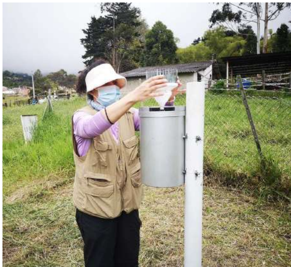
Totalizador isotópico ubicado en la estación climatológica Escuela Agrícola de Cáchira- Norte de Santander del IDEAM. Red Nacional de Isotopía.
