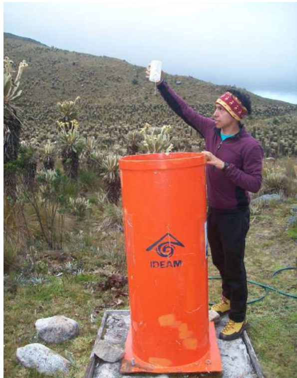
Figura 7-6. Vertimiento de la solución anticongelante dentro del pluviómetro totalizador de nieve del IDEAM ubicado en el Nevado del Cocuy.
