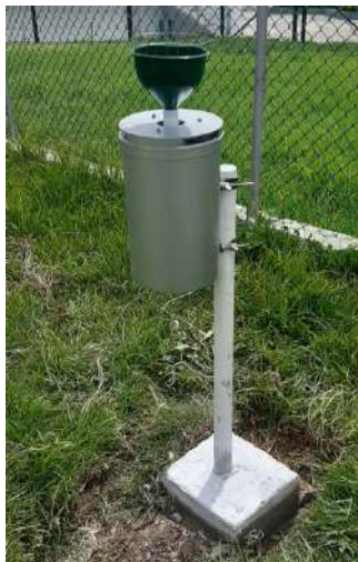
Figura 10-13. Totalizador Rain Sampler RS1, ubicado en las Estación climatológica del IDEAM, Duitama- Red Nacional de Isotopía- IDEAM.
