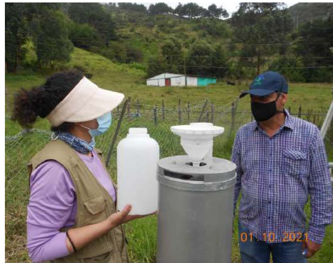
Totalizador isotópico ubicado en la estación climatológica Escuela Agrícola de Cáchira- Norte de Santander del IDEAM. Red Nacional de Isotopía.
