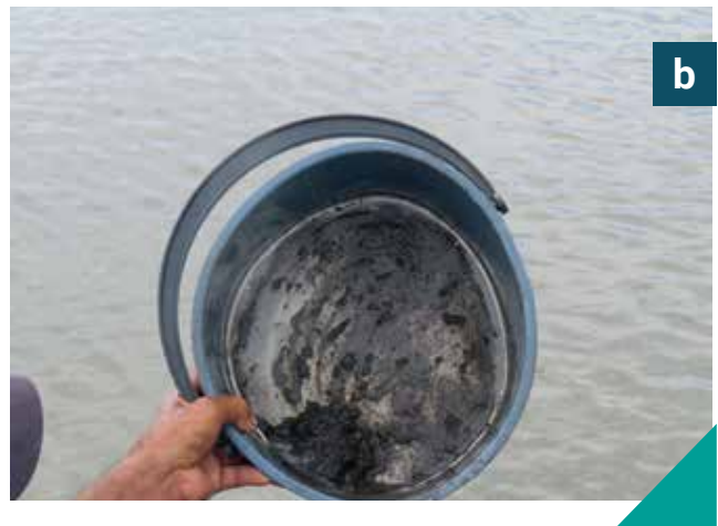
Fotografías 1 a y b. Muestreo en campo de macroinvertebrados asociados a fondos blandos. a) Draga tipo Eckman, b) Malla de 250 µm.
