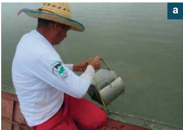
Fotografías 1 a y b. Muestreo en campo de macroinvertebrados asociados a fondos blandos. a) Draga tipo Eckman, b) Malla de 250 µm.
