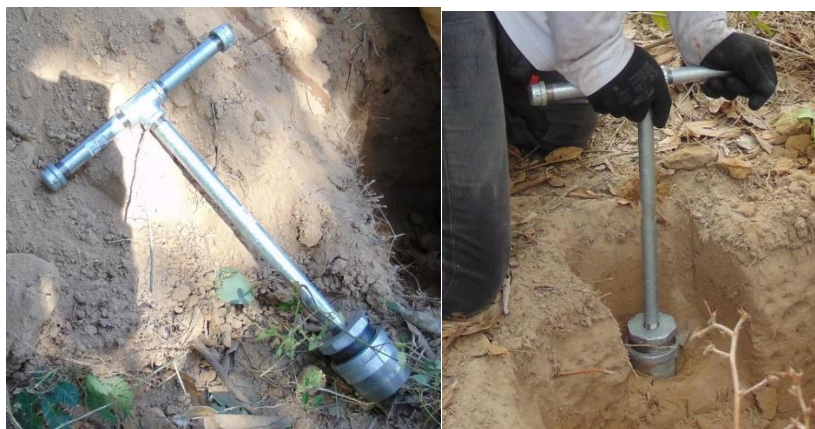
Figura 40. Técnica para tomar muestras de densidad aparente del suelo. Fuente: elaboración propia (2024).
