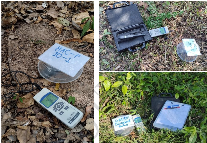
Figura 38. Cámara de medición de flujo de CO 2 en suelos. Fuente: elaboración propia (2024).
